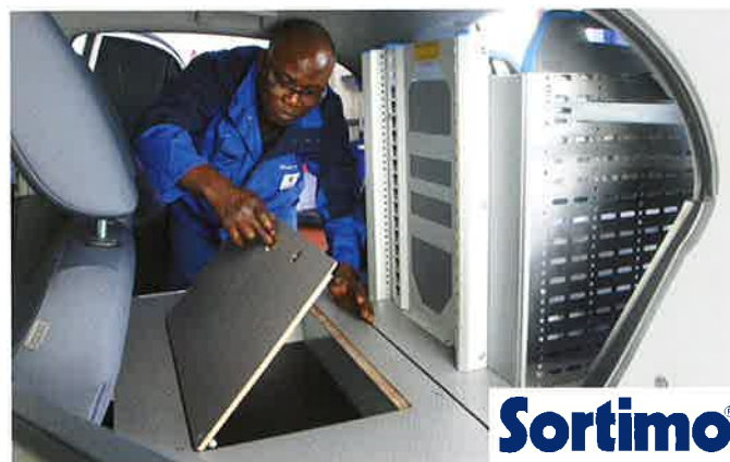
Der Sobogrip-Montageboden bietet eine zusätzliche Unterboden-Klappe.
