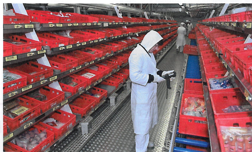
Ein automatisches Kistenlager als Produktions-, Kommissionier- und Versandlager gewährleistet hohe Prozess- und Datensicherheit.
