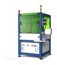
Bei der VICO Laser handelt es sich um ein selektives Laserlötsystem. Durch den Einsatz eines Diodenlasers können selbst kleinste Kontaktflächen mit einem Durchmesser von 0,3 mm gezielt erhitzt werden. Anhand vorgegebener Parameter regelt ein Echtzeit-
