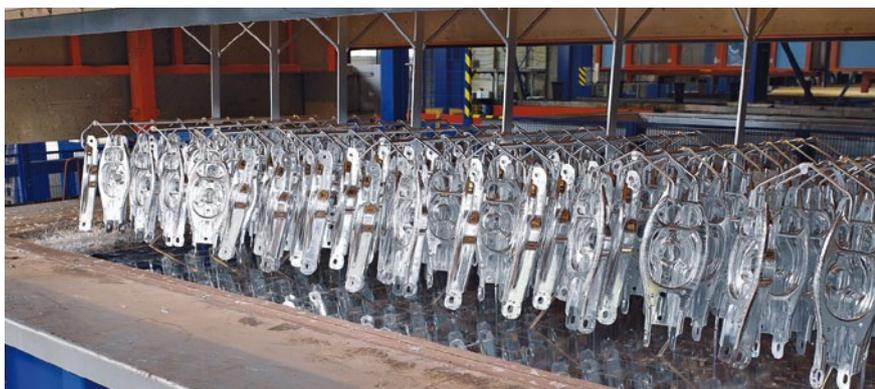
Bild 1: Pkw-Unterbodenteile mit neuartiger Dünnschicht-Verzinkung
