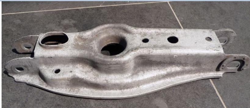
Bild 3: Unterbodenteil nach sechs Jahren (gereinigt)
