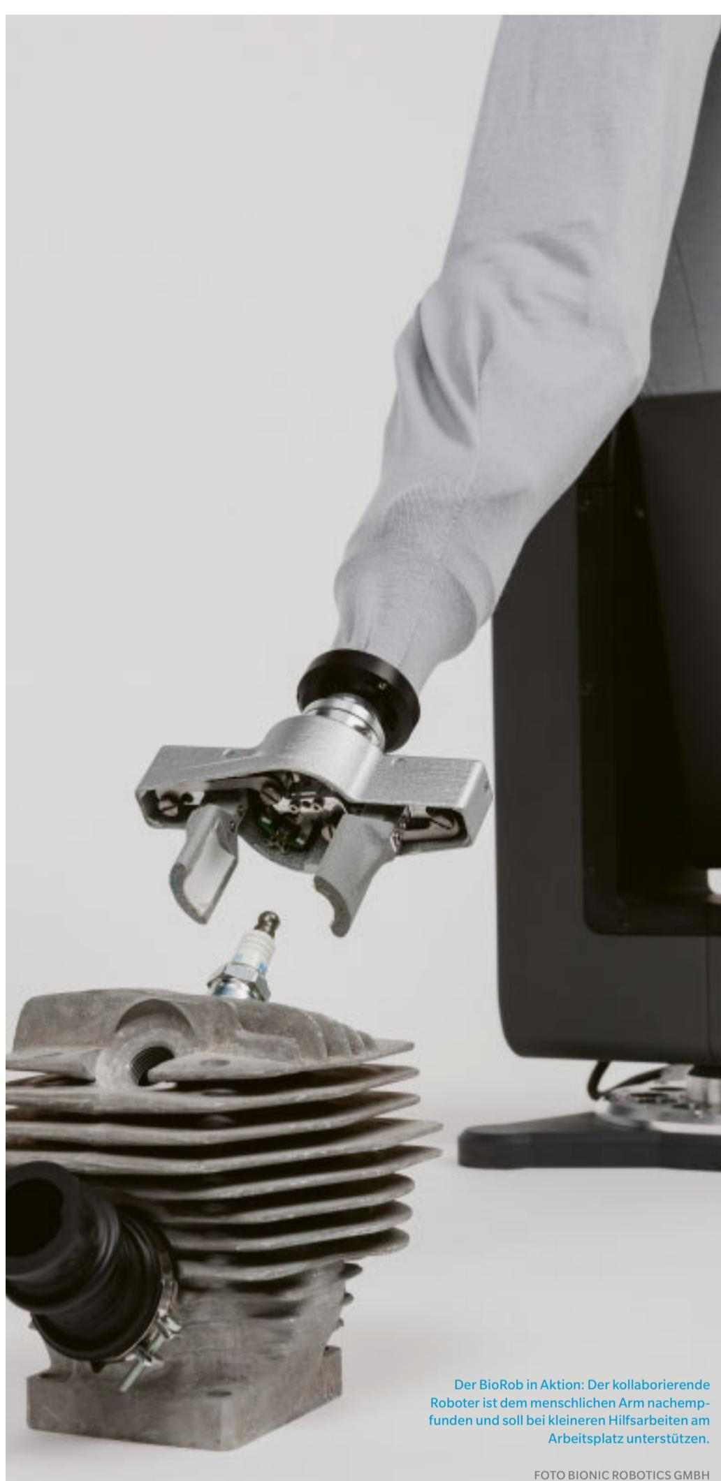
Der BioRob in Aktion: Der kollaborierende Roboter ist dem menschlichen Arm nachempfunden und soll bei kleineren Hilfsarbeiten am Arbeitsplatz unterstützen.
