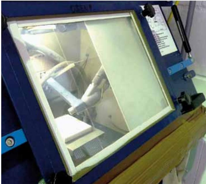
Einsatz als verschleißresistente Scheiben in einer Strahlkabine (links PERLUCOR, rechts Glas)
