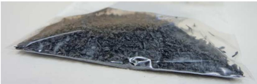
Backofen kleben. Im Labor haben wir das Ausheizen trotzdem ausprobiert, ohne wirklichen Erfolg. So reduzierte sich die Phenol-Konzentration in der iProtect-Schutzhülle nach einstündigem Ausheizen bei 70
