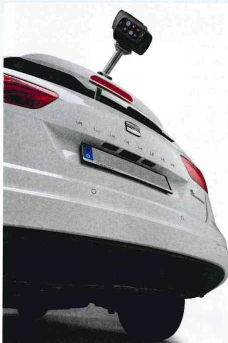
Mobiler Straßensensor, der sich an verschiedene Fahrzeuge montieren lässt und umfangreiche Daten liefert
