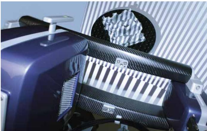
◀ Qualitätskontrolle, 3D-Inspektion, Reverse Engineering – die Streifenprojektion von Weißlicht-Scannern dient zum berührungslosen dreidimensionalen Erfassen von Oberflächen.
