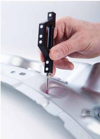
▲ Der 15 cm große Messtaster misst geometrische Feinheiten und gibt die Daten an die Auswertesoftware weiter. Am Gerät befinden sich Messpunkte, die die Kameras des Weißlichtscanners automatisch erkennen.
