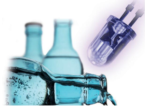
Leuchtdioden auf Basis von Aluminiumnitrid können Wasser und Luft energieeffizient desinfizieren
