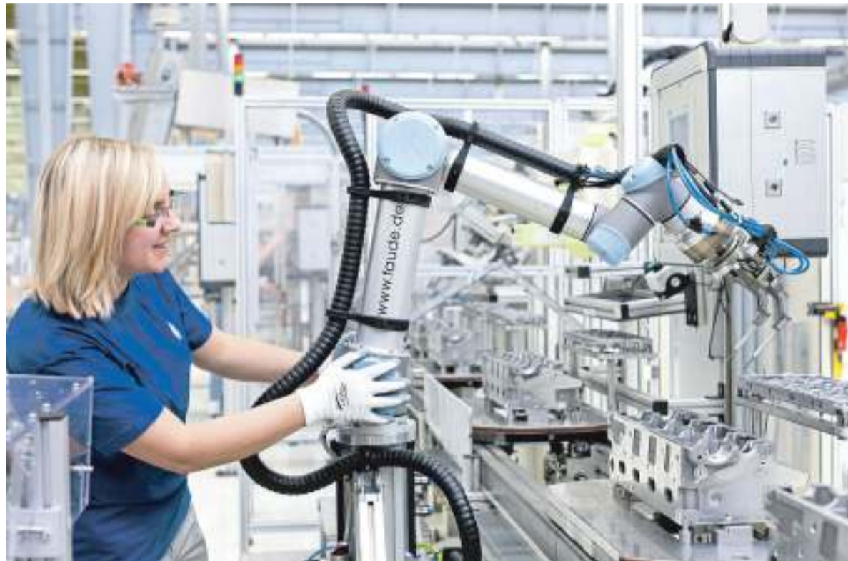
Ein Industrieroboterarm bewegt im Volkswagen-Werk Salzgitter empfindliche Glühstiftkerzen, die in Motoren des Autobauers montiert werden. Volkswagen erprobt erstmals in seiner Produktion den direkten Schulterschluss von Mensch und Maschine.
