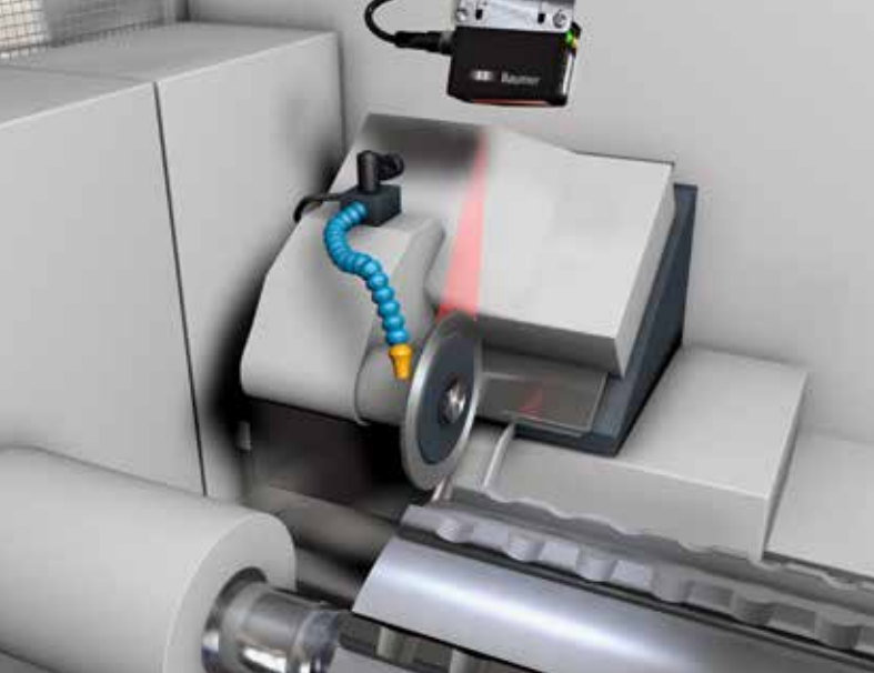
Beispiel: Messung des Durchmessers einer Schleifscheibe in einer CNC Maschine
