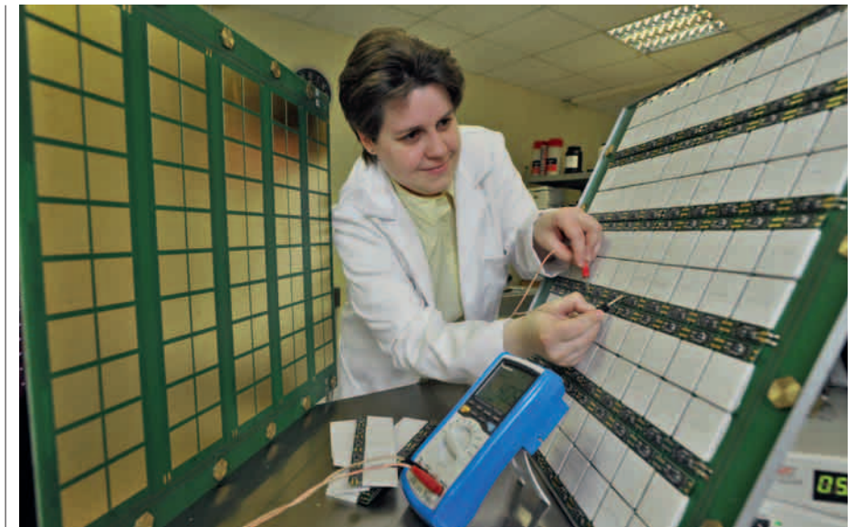
MESSUNG DER SPANNUNG an thermischen Transmittern.
