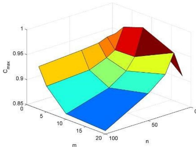
3D-Plot der erreichten Ergebnissen in Abhängigkeit von der Maschinenanzahl  $m$  und der Produktanzahl  $n$ . Das Ergebnis zeigt, dass sich die Zykluszeit tendenziell mit steigender Produkt- und Maschinenanzahl verbessert. Jedoch hat sich bei den Benchmarks gezeigt, dass eine große Maschinenanzahl ( $m=20$ ), gepaart mit einer kleinen Produktanzahl ( $n=10$ ), ebenfalls ein großes Optimierungspotential besitzt.
