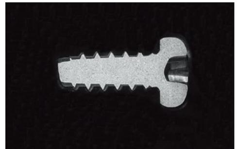
Querschnitt durch Metall (20×)
