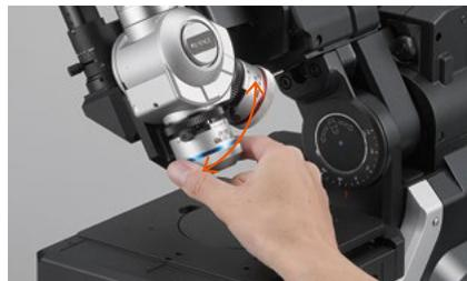
Das kompakte Design des zweifachen Zoomobjektivs und die Flexibilität des Stativs mit freier Winklereinstellung ermöglichen es, das Messobjekt aus unterschiedlichen Winkeln und unter jeder Vergrößerung zwischen 20x und 2000x zu betrachten.
