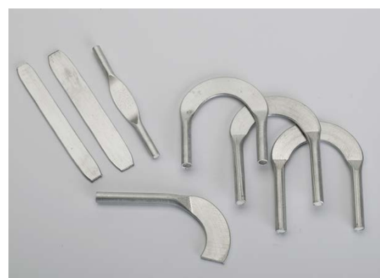
Abbildung 10: Gepresste und gewalzte Einlegerohre und Profile realisieren unterschiedliche Konturen.
