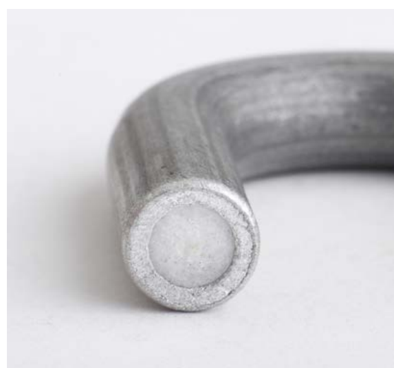
Abbildung 4: Die Wanddicke hängt vom gewünschten Biegeradius ab.
