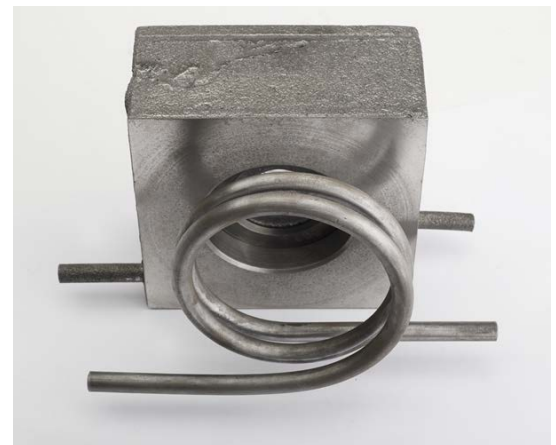
Abbildung 7: Im Eisenguss verwendete Rohrwendel für einen Kühlkanal.
