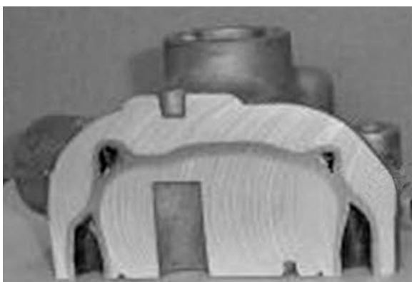
Abbildung 5: Das im herkömmlichen Verfahren eingegossene Stahlrohr kollabiert (links). Der stabile, gefüllte combicore-Gießkern behält seine Form (rechts).
