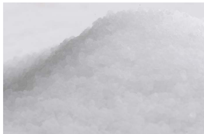
Abbildung 6: Der Formstoff stabilisiert das Rohr.
