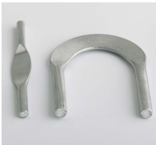
Abbildung 2: Fülldrahtkerne für Stegkühlungen in Motorblöcken ersetzen traditionelles Bohren.
