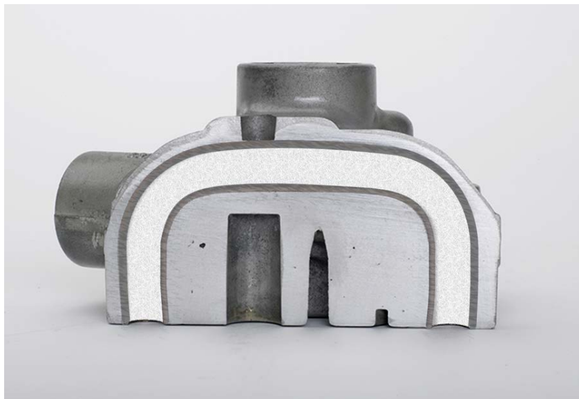
Abbildung 1: Der Schnitt durch einen eingegossenen combicore-Kern dokumentiert dessen Stabilität im Druckguss.
