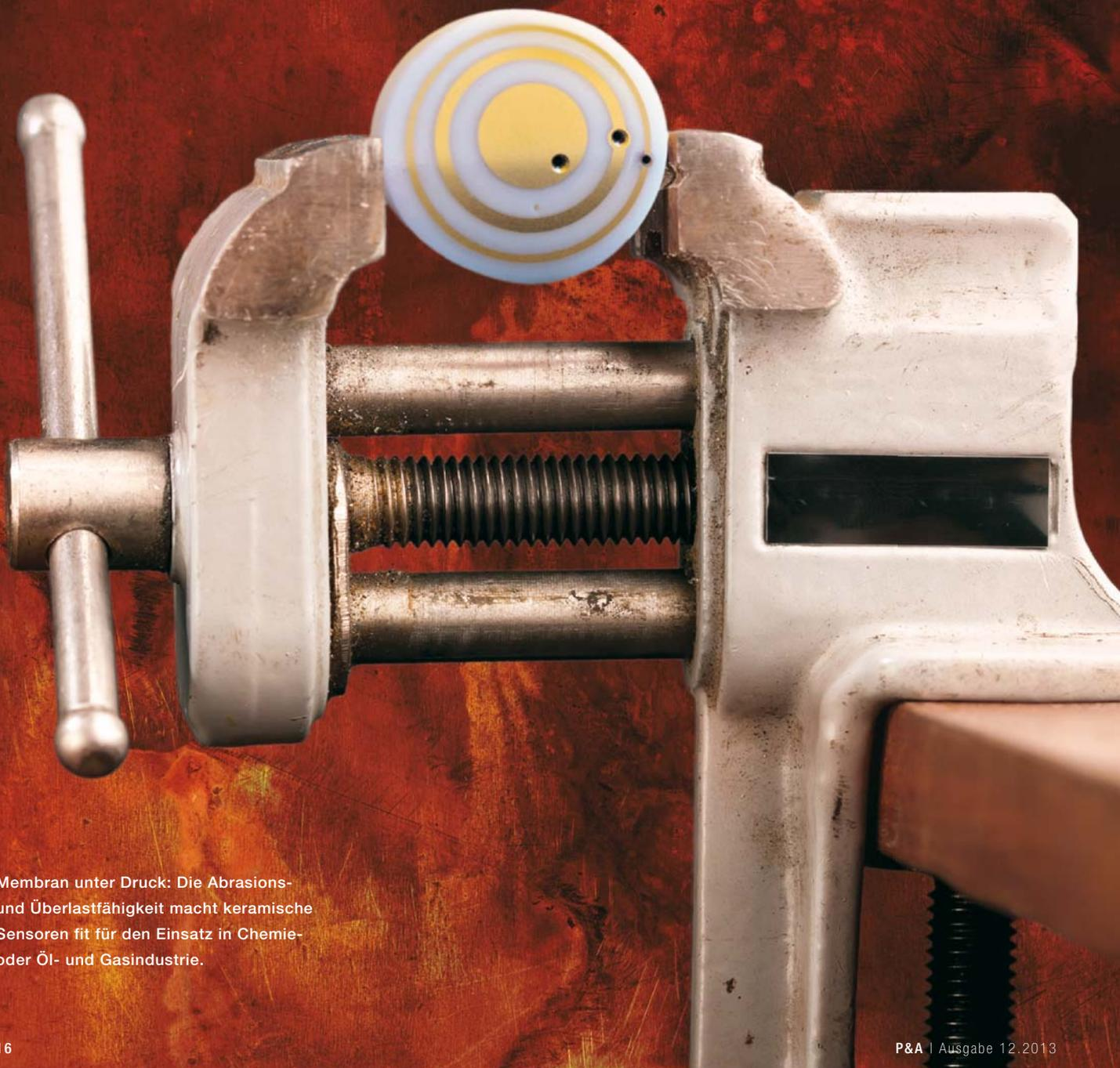
Membran unter Druck: Die Abrasions- und Überlastfähigkeit macht keramische Sensoren fit für den Einsatz in Chemie- oder Öl- und Gasindustrie.
