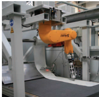
BILD 5 Kontinuierliche Zufuhr- und Zuschnitteinheit der Preforming-Anlage
