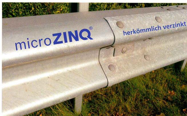
Bild 3: Teststrecke microZINQ®-verzinkter Leitplanken
