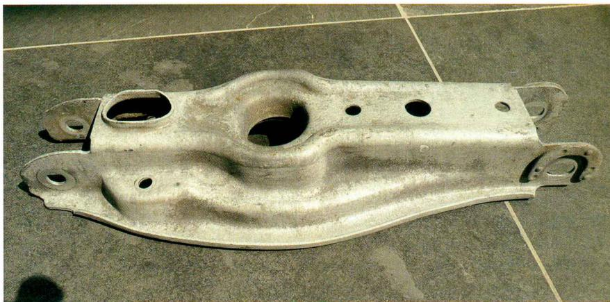
**Bild 2: Unterbodenteil nach sechs Jahren (gereinigt von verkehrsbedingten Verschmutzungen)**
