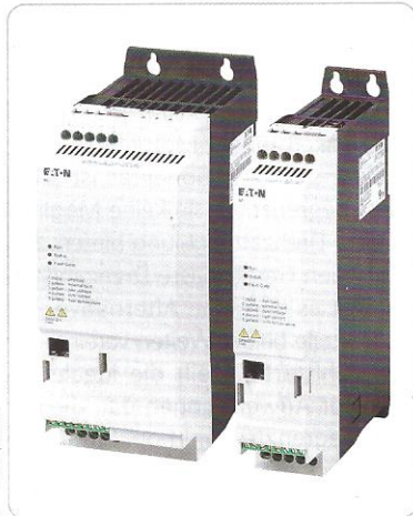
Bild 2: Die Version FS2 in 90mm Breite ist für Leistungen von 2,2 bis 7,5kW ausgelegt. Mit der 45mm schmalen Version FS1 lassen sich Motoren von bis zu 1,5kW ansteuern.
