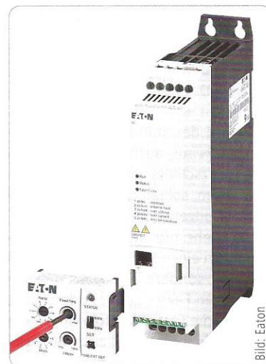
Bild 4: Bei Bedarf kann der Bediener mit dem Schraubendreher und einem aufsteckbaren Konfigurationsmodul die wichtigsten Parameter individuell verändern. Der Parametersatz kann zudem unkompliziert auf weitere Drehzahlstarter übertragen werden.
