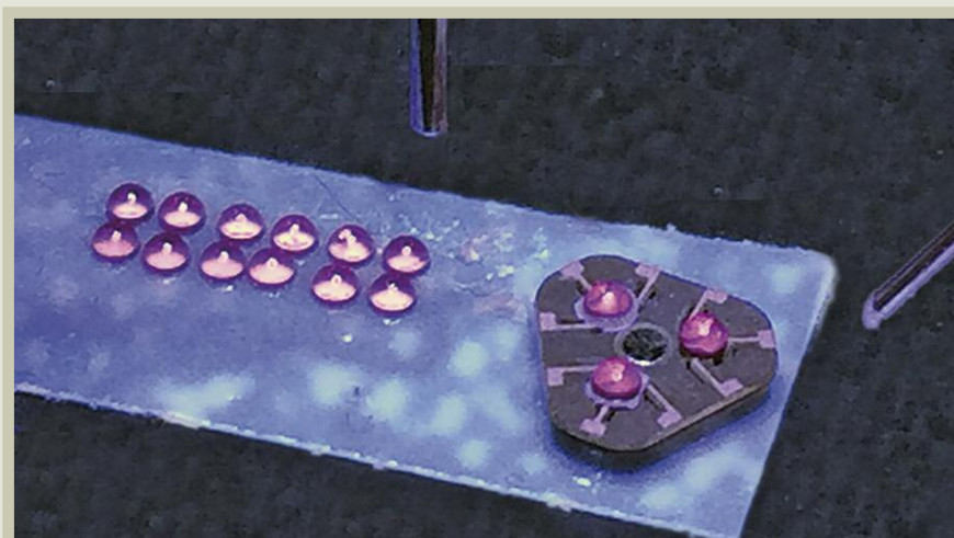
Bild 5. Montageszene: Rubinhalbkugeln mit einem Durchmesser von 1 mm werden mit dem Vakuumgreifer (oben) aufgenommen und auf die mit Klebstoff benetzten Elektrodenstrukturen des Nanomotors gesetzt. Der Nanomotor hat eine Größe von etwa 5 mm × 5 mm. Rechts im Bild ist die Nadel des Dispensers zu erkennen
