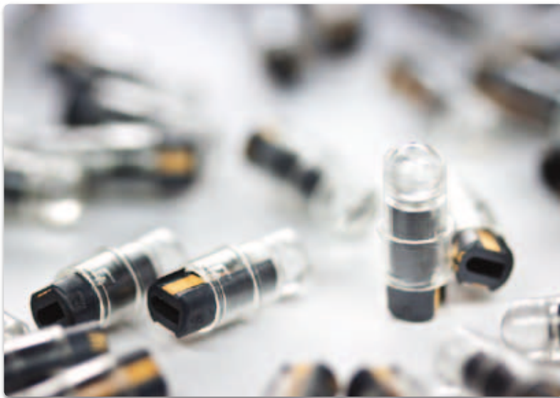
MID-LED: Das Leuchtelement wurde mit dem MID-LDS-Verfahrens (Laserdirektstrukturieren) hergestellt und lässt sich in verschiedenen Bereichen einsetzen.
